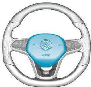
Hình 31 Vị trí lắp đặt và phạm vi giãn nở của túi khí phía trước dành cho người lái
