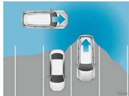
Hình 133 Phạm vi giám sát xung quanh khi xe rời khỏi chỗ đỗ (sơ đồ minh họa)
