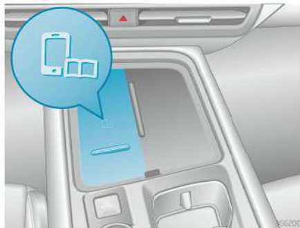
Hình 145 Đệm và logo sạc không dây (hình phóng to)
