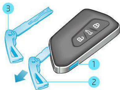
Hình 41 Chìa khóa xe: mở khóa khẩn cấp
