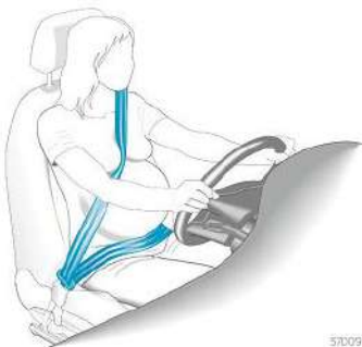
Hình 29. Hướng thắt dây an toàn đúng cách cho phụ nữ mang thai (sơ đồ minh họa)
