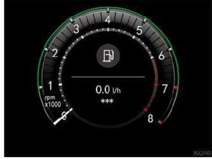
Hình 11 Đồng hồ đo vòng tua động cơ
