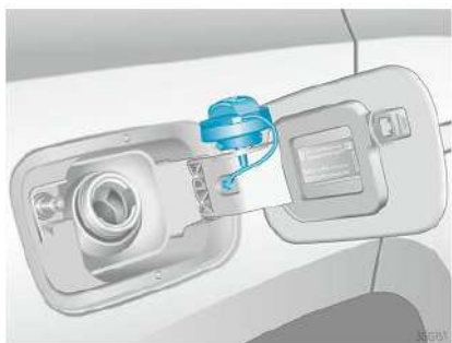
Hình 156 Có thể treo nắp bình xăng đã tháo vít lên cửa bình xăng đang mở.
