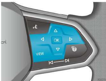
Hình 16 Bên phải vô lăng đa chức năng: vận hành cụm đồng hồ kỹ thuật số (số đo minh họa)
