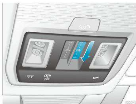
Hình 63 Trên trần: đóng rèm cuốn che nắng
