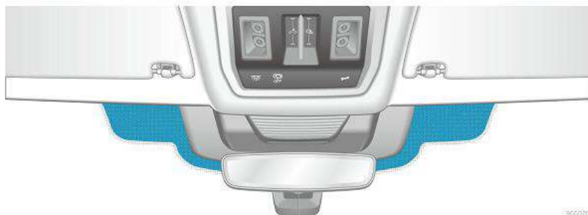
Hình 97 Kính chắn gió phủ kim loại phản xạ hồng ngoại với cửa sổ giao tiếp (vùng màu xanh)
