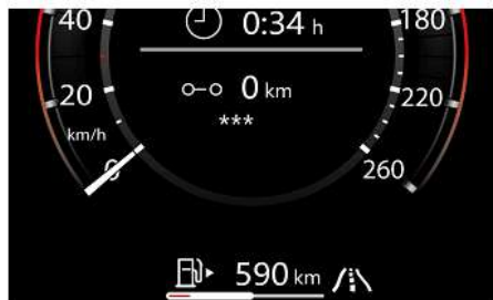
Hình 12. Trên cụm đồng hồ kỹ thuật số: đồng hồ đo nhiên liệu (sơ đồ minh họa)
