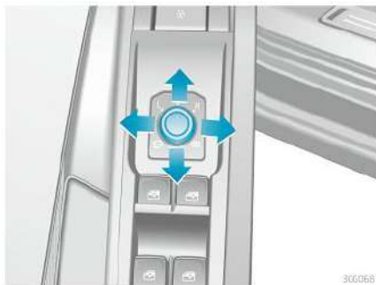
Hình 95 Bên trong cửa lái: nút điều chỉnh gương chiếu hậu ngoài
