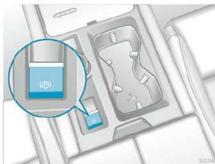
Hình 124 Trên bảng điều khiển trung tâm: nút phanh tay điện tử
