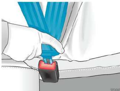
Hình 26: Lắp lười khóa dây an toàn vào khóa dây an toàn (sơ đồ minh họa)
