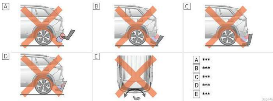
Hình 55 Minh họa thao tác sai khi đá vào nắp cốp cảm ứng
