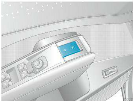
Hình 46 Ở cửa lái: nút khóa cửa trung tâm
