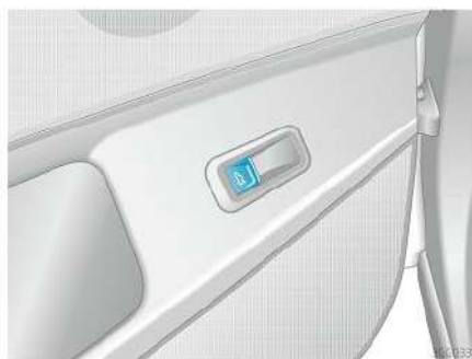
Hình 50 Ổ cửa lái: nút mở khóa nắp cốp
