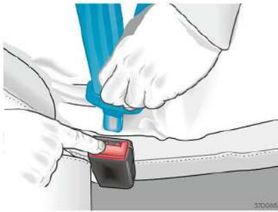
Hình 27. Tháo lưỡi khóa khỏi khóa dây an toàn (sơ đồ minh họa)
