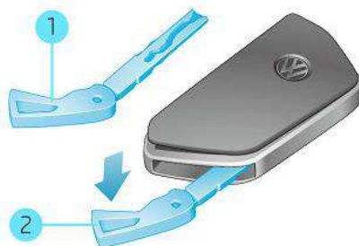
Hình 42. Chìa khóa xe: mở nắp hộp pin
